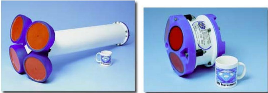
Dos ejemplos de un ADCP. Las piezas coloreadas anaranjadas son los transmisores/receptores de sonido, el cilindro blanco contiene la electrónica. El instrumento a la izquierda se diseña para aplicaciones en aguas profundas; tiene una resolución de 32 m y un rango de 600 m. El instrumento a la derecha es un diseño típico para aguas someras; su resolución se puede variar entre 1 m y 4 m, lo que le da un rango desde 20 m hasta unos 110 m.
